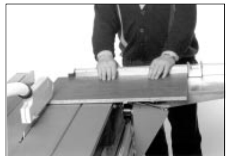
Schiebeschlitten und Werkstück zurückziehen. Das Werkstück um 180° drehen und mit der im 1. Arbeitsgang winkelig geschnittenen Kante gegen der heruntergeklappten Reiter legen. Danach den 2. Schnitt durchführen.
